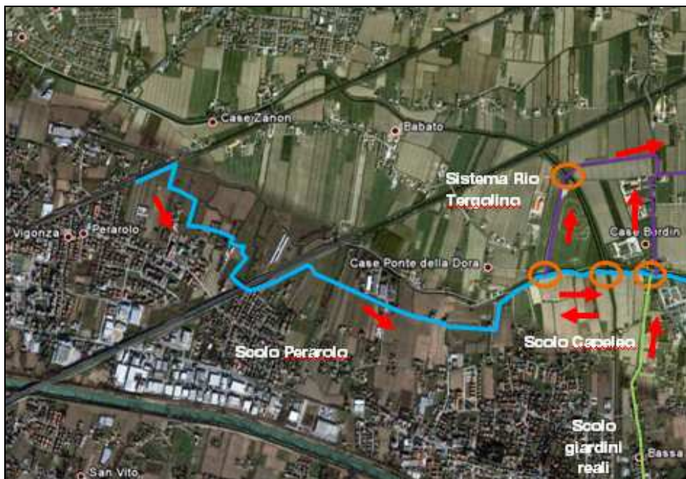
Figura 16: Scolio Capeleo (ciano) fino al Nodo idraulico Fiesso d'Artico Nord-Ovest B, cerchiati gli attraversamenti con botte a sifone.
